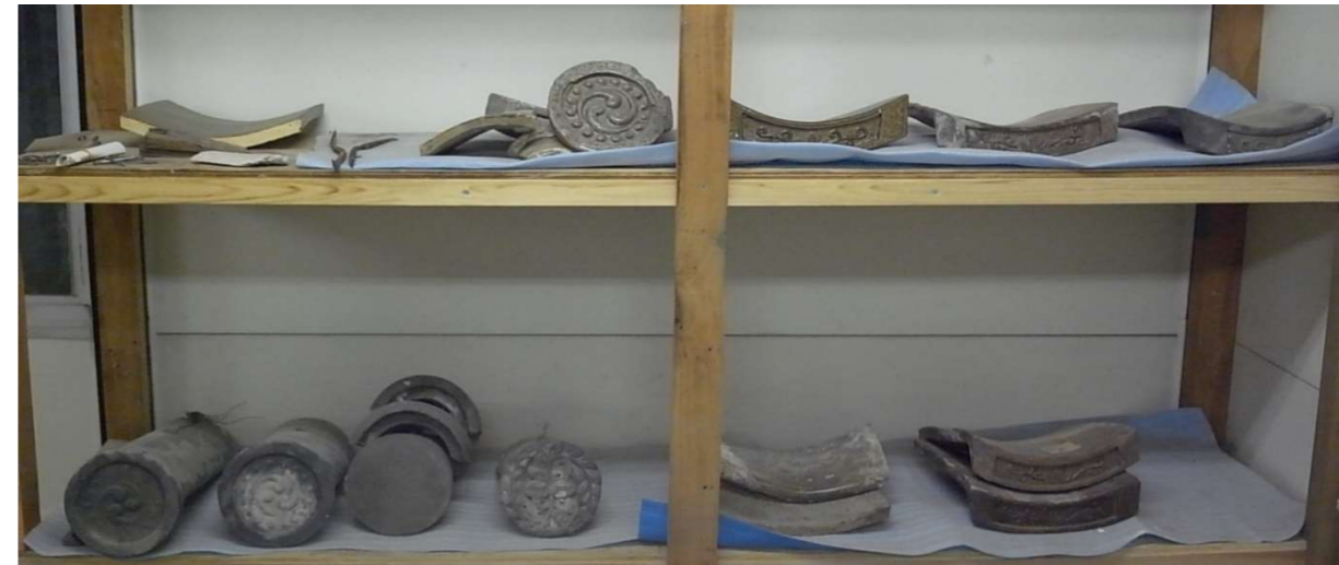
資料04 燻瓦、灰釉、柿釉瓦は、不再用の在来品・新規作成品を保管
